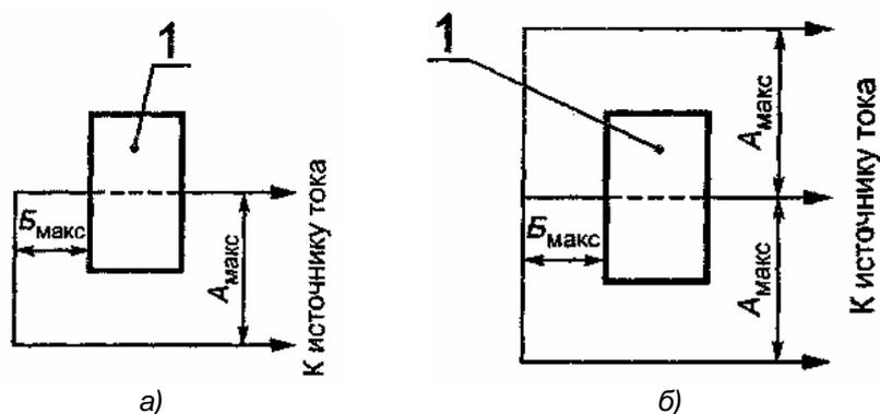
1 — испытываемый трансформатор  $A_{\text{макс}}$  — расстояние между осями проводников соседних фаз в месте установки трансформатора в эксплуатации — расстояние в свету от трансформатора до места ближайшего изгиба проводника служащего в эксплуатации первичной обмоткой трансформатора
